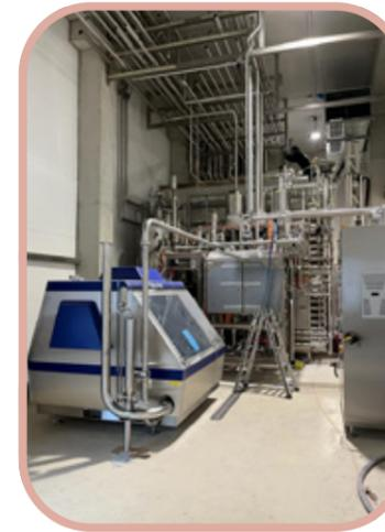
Procomac Füllerblock gekoppelt mit Blowmoulder, Leistung: 18.000 Flaschen/Std.
