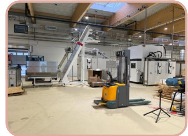
Blowmoulding-Anlage – Preformschütte, Heizzunnel, Blasstationen
